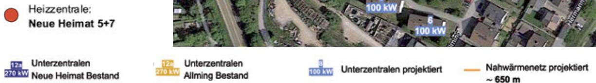
Es wird eine Energiezentrale zur Wärmeerzeugung als Hybridanlage in Kombination einer Holzpellet-Doppelkesselanlage (75 Prozent) und einem Gasbrennwertkessel (25 Prozent) geplant. Von der Zentrale erfolgt die Wärmeverteilung in die einzelnen Gebäude über das Nahwärmenetz in Zwei-Leiter-Technologie, bevor sie über Wärmetauscher und Hausverteiler im Untergeschoss in jeder Wohnung zur Verfügung steht. Die Warmwasserbereitung erfolgt dezentral in jedem einzelnen Objekt.
